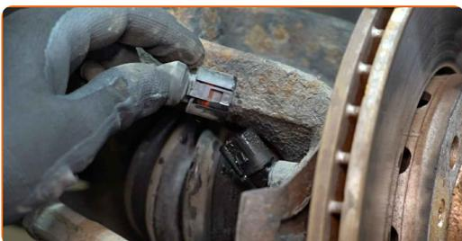
**8** Vyčistite upevnenie ABS snímača. Použite drôtenú kefu. Použite sprej WD-40.
