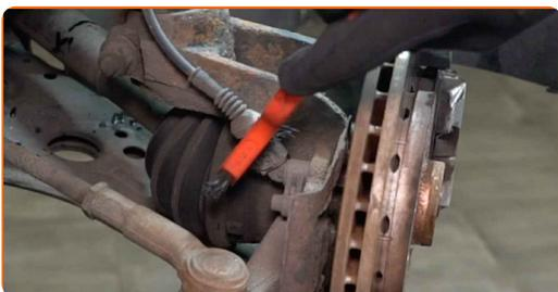
**7** Odpojte konektor ABS snímača. Použite plochý skrutkovač.
