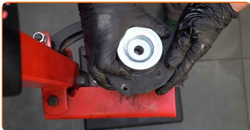
**39** Upevnite maticu piestu vzpery tlmiča. Použite imbusový kľúč č. H7. Použite nástavec č.21. Použite momentový kľúč.
