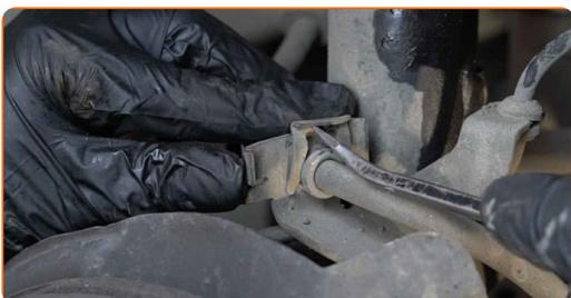
**19** Odpojte vodiče snímača ABS.
