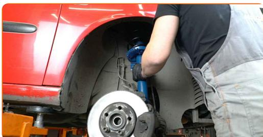
**46** Zaskrutkujte vrchné upevnenie uloženia vzpery tlmiča. Neuťahujte ho.
