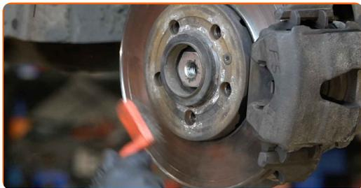
**68** Natrite povrch, kde je brzdový kotúč v kontakte s ráfikom kola. Použite medené mazivo.
