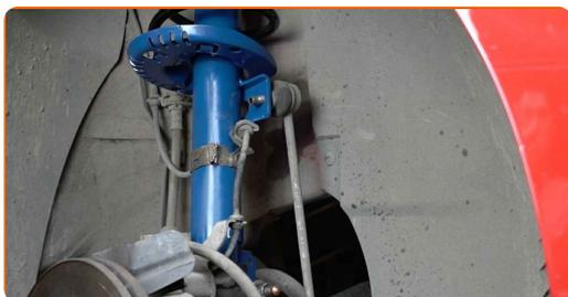
**65** Utiahnite upevnenie spájajúce vzperu stabilizátora k vzpere tlmiča. Použite nástavec č.17. Použite momentový kľúč. Utiahnite ju krútiacim momentom 40 Nm.
