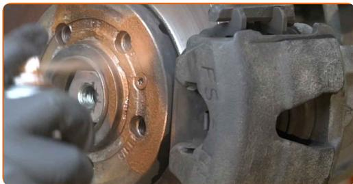
**69** Vyčistíte povrch brzdového kotúča. Použite čistič brzd.
