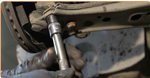
**55** Utiahnite upevnenie guľového čapu. Použite nástavec č.13. Použite momentový kľúč. Utiahnite ju krútiacim momentom 20 Nm.+90°
