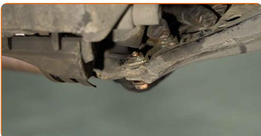
**54** Zaskrutkujte upevňovacie prvky guľového čapu. Použite nástavec č.13. Použite ráčňový kľúč.
