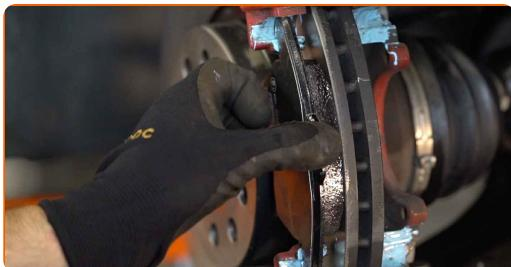
Výmena: brzdových platničiek – VW Polo Hatchback (6R1, 6C1). Tip:
