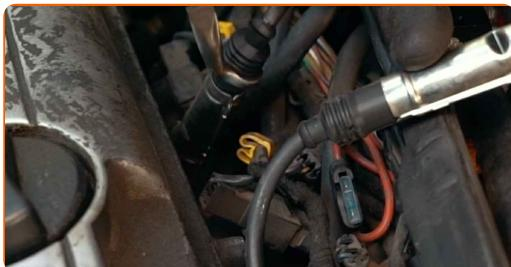
Výmena: zapal'ovacích sviečok – VW Polo Hatchback (86C, 80). Tip od AUTODOC:
