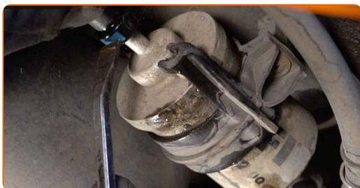
Výmena: palivového filtra – VW Polo III Hatchback (6N2). Profesionáli odporúčajú:
