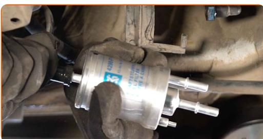
**12** Uťahnite upevňovacie prvky palivového filtra. Použite krížový skrutkovač PH.
