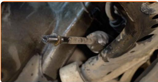
**12** Vyčistite montážne pozície čapu tiahla riadenia. Použite drôtenú kefu. Použite sprej WD-40.
