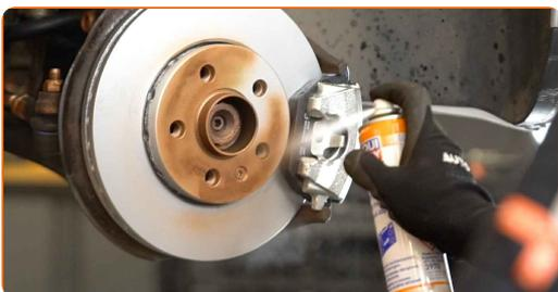
21 Vyčistite povrch brzdového kotúča. Použite čistič brzd.
