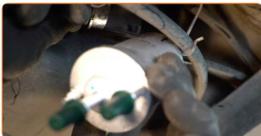
**13** Utiahnite upevňovacie prvky palivového filtra. Použite krížový skrutkovač PH.
