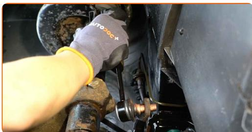
**12** Zaskrutkujte upevňovacie prvky závesu stabilizátora. Použite kombinačný kľúč č.16. Použite nástavec č.19. Použite ráčňový kľúč.
