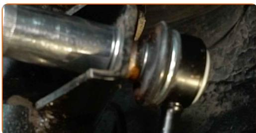
**13** Utiahnite upevnenie spájajúce vzperu stabilizátora k stabilizátoru. Použite nástavec č.17. Použite momentový kľúč. Utiahnite ju krútiacim momentom 100 Nm.
