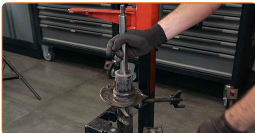
Výmena: jednotka pruženia, tlmič pruženia – VW TIGUAN (5N\_). AUTODOC odporúča:
