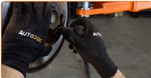
Výmena: brzdových kotúčov – VW Transporter IV Valník / Podvozok (70E, 70L, 70M, 7DE, 7DL). Profesionáli odporúčajú:
