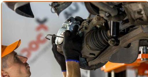
Výmena: ložiska kolesa – VW Transporter IV Valník / Podvozok (70E, 70L, 70M, 7DE, 7DL). Tip:
