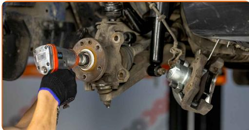
Výmena: ložiska kolesa – VW Transporter IV Valník / Podvozok (70E, 70L, 70M, 7DE, 7DL). Tip od odborníkov z AUTODOC:
