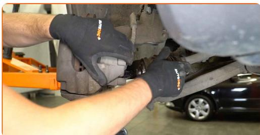
30 Vyčistite upevňovacie prvky spájajúce vzperu tlmiča a hlavu ložiska čapu kola. Použite drôtenú kefu. Použite sprej WD-40.
