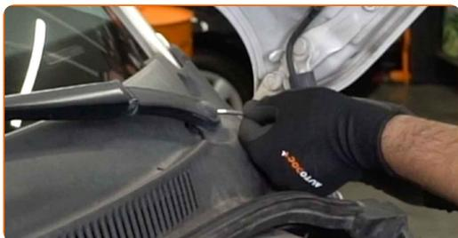
**4** Vyčistite upevňovacie prvky ramien stieračov. Použite drôtenú kefu. Použite sprej WD-40.
