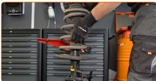
Výmena: horného uloženia tlmiča – VW Transporter V Bus (7HB, 7HJ, 7EB, 7EJ, 7EF, 7EG, 7HF, 7EC). Tip:
