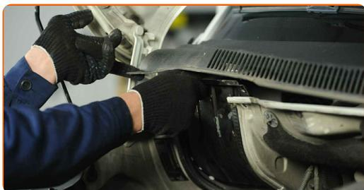
**60** Utiahnite montážne skrutky ochranného krytu. Použite hviezdicový Torx T30. Použite ráčňový kľúč.
