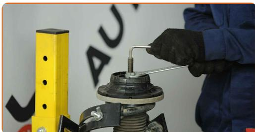
**46** Odstráňte vrchné uloženie vzpery. Použite páčidlo.
