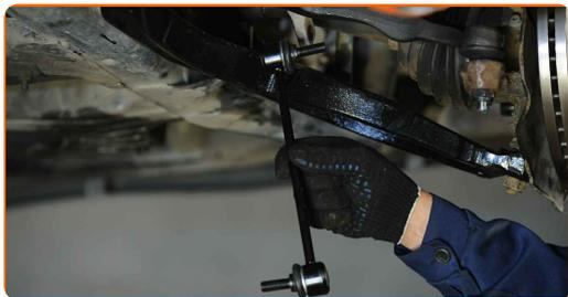
**12** Utiahnite upevnenie spájajúce vzperu stabilizátora k stabilizátoru. Použite kombinačný kľúč č.19. Použite imbusový kľúč č. H5. Použite momentový kľúč. Utiahnite ju krútiacim momentom 60 Nm.+45°
