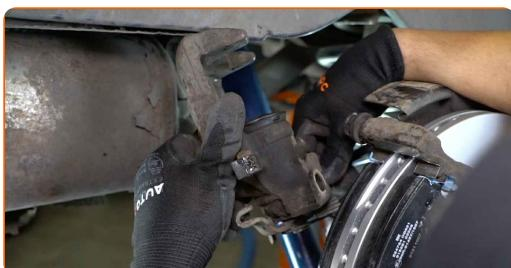
Výmena: brzdových strmenov – VW Transporter V Valník / Podvozok (7JD, 7JE, 7JL, 7JY, 7JZ, 7FD). AUTODOC odporúča:
