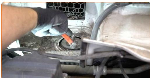
**40** Odskrutkujte horné upevňovacie prvky uloženia tlmiča. Použite kombinačný kľúč č.21. Použite imbusový kľúč č. H7. Použite ráčňový kľúč.
