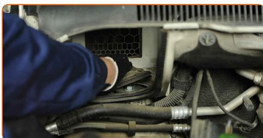
**39** Vyčistite horné upevnenie uloženia tlmiča. Použite drôtenú kefu. Použite sprej WD-40.
