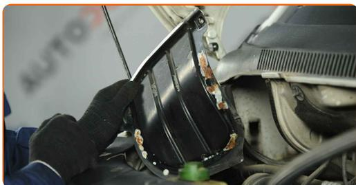
**38** Odstráňte kryt ložiska vzpery tlmiča. Použite páčidlo.
