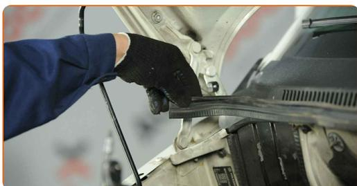
**36** Odskrutkujte montážne skrutky ochranného krytu. Použite hviezdicový Torx T30. Použite ráčňový kľúč.
