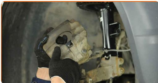
Výmena: brzdových strmenov – VW Transporter VI Valník / Podvozok (SFD, SFE, SFL, SFZ). Profesionáli odporúčajú:
