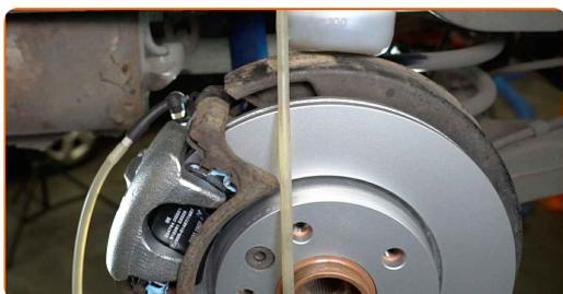
**26** Odpojte skrutku prvku na odvzdušnenie brzd. Použite kľúč na prevlečné matice #11.
