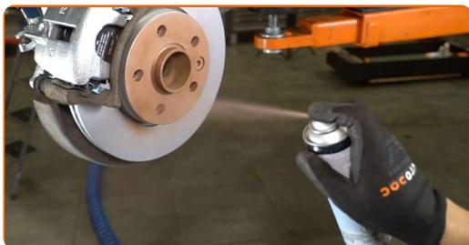
**32** Vyčistíte povrch brzdového kotúča. Použite čistič brzd.
