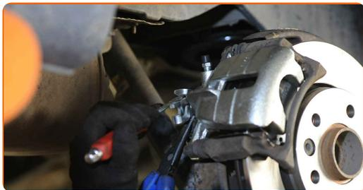
**24** Vyčistite špinu zo skrutky brzdovej hadice. Použite čistič brzd.
