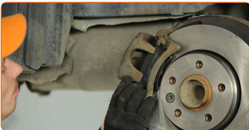
Výmena: brzdových strmenov – VW Transporter VI Valník / Podvozok (SFD, SFE, SFL, SFZ). AUTODOC odporúča:
