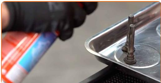
**26** Namažte vodiace závlačky brzdového strmeňa. Použite mazivo na vodiace závlačky brzdového strmeňa.
