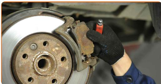
**13** Vyčistite upevňovacie prvky držiaka brzdového strmeňa. Použite drôtenú kefu. Použite sprej WD-40.
