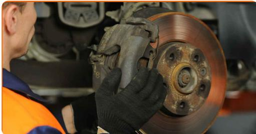
Výmena: brzdových kotúčov – VW Transporter VI Van (SGA, SGH).
