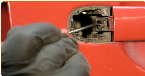
Výmena: zámku dveří – VW Transporter VI Van (SGA, SGH). Tip od AUTODOC:
