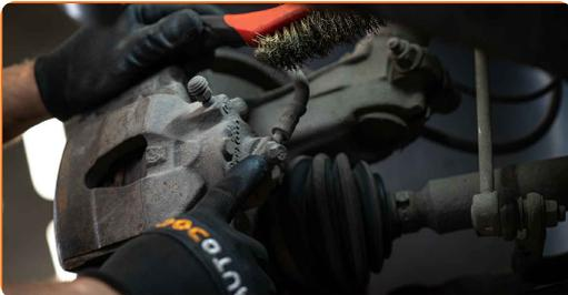
Výmena: brzdových strmenov – VW up! Hatchback (121, 122, BL1, BL2). Tip:
