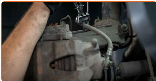
**12** Odskrutkujte prvky brzdovej hadičky od brzdového strmeňa. Použite kombinačný kľúč č.11. Brzdovú hadicu dajte nabok. Privažte brzdovú hadicu ku karosérii pomocou háčika alebo drôtu.
