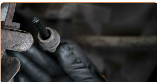
**20** Vyčistíte zvyšky starého maziva a stopy hrdze, ak tu sú, z vodiacich závlačiek strmeňa a z puzdier vodiacich závlačiek. Použite čistič brzd.
