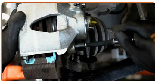
Výmena: brzdových strmenov – VW up! Hatchback (121, 122, BL1, BL2). Tip od AUTODOC:
