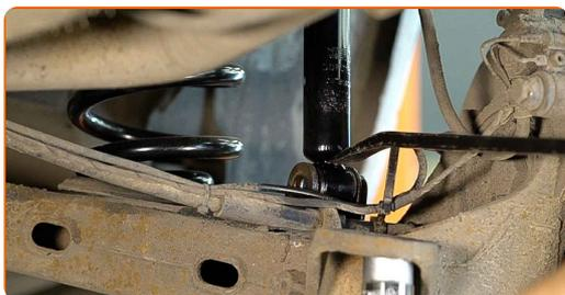
19 Podoprite nosník zadného odpruženia kolies. Použite zdvihák s hydraulickými prevodmi.
