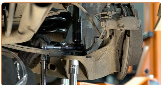
21 Odstráňte upevnenie spod nosníka zadnej nápravy.
