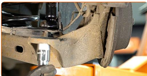
20 Uťahnite spodné upevnenie tlmiča. Použite nástavec č.21. Použite momentový kľúč. Uťahnite ju krútiacim momentom 133 Nm.
