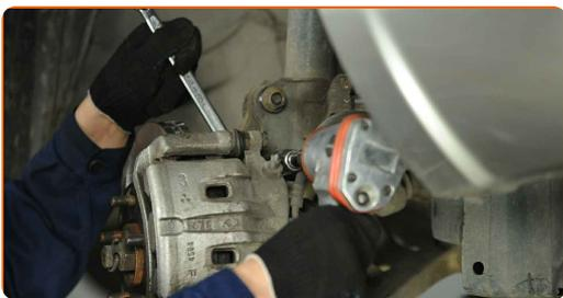
**33** Pripojte upevňovací prvok ABS snímača a jeho kábla k vzpere tlmiča.
