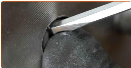
**24** Očistite brzdový strmeň od prachu a špiny. Použite drôtenú kefu. Použite čistič brzd.
