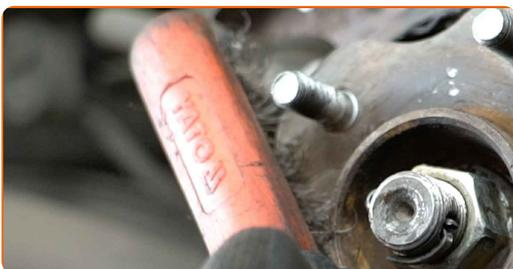
**20** Natrite kontaktný povrch. Použite keramické mazivo.
