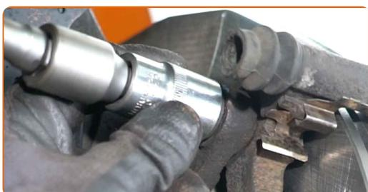
**28** Natrite piest brzdového strmeňa. Použite nylonovú čistiacu kefu. Použite čistič brzd.
