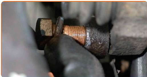
**27** Utiahnite upevňovacie prvky držiaka brzdového strmeňa. Použite nástavec č.19. Použite momentový kľúč. Utiahnite ju krútiacim momentom 80 Nm.
