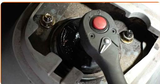
**5** Uvoľnite horné upevňovacie prvky tlmiča. Použite nástavec č.14. Použite ráčňový kľúč.
