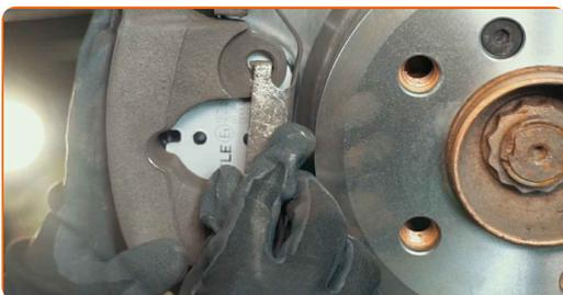
**20** Utiahnite upevňovacie prvky brzdového strmeňa. Použite imbusový kľúč č. H7. Použite momentový kľúč. Utiahnite ju krútiacim momentom 30 Nm.
