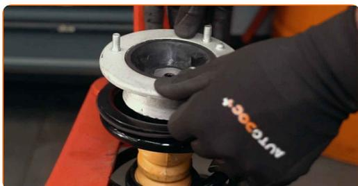
**41** Upevnite maticu piestu vzpery tlmiča. Použite nástavec č.19. Použite imbusový kľúč č. H6. Použite momentový kľúč. Utiahnite ju krútiacim momentom 64 Nm.
