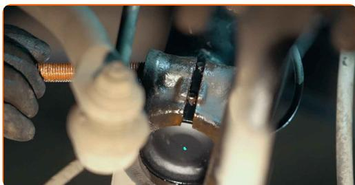
**52** Zaskrutkujte upevňovací prvok, ktorý spája tmič k hlave ložiska čapu. Použite kombinačný kľúč č.16. Použite nástavec č.18. Použite ráčňový kľúč.
