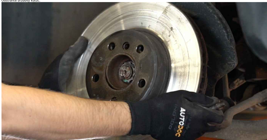
22 Vyčistíte náboj. Použite drôtenú kefu. Natrite kontaktný povrch. Použite medené mazivo.
