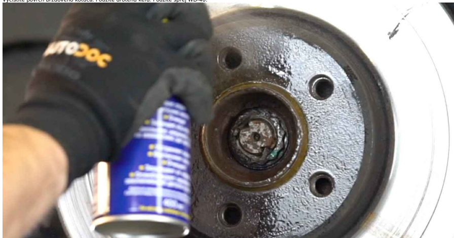
20 Odskrutkujte upevnenie brzdového kotúča. Použite hviezdicový Torx T30. Použite nárazový skrutkovač.
