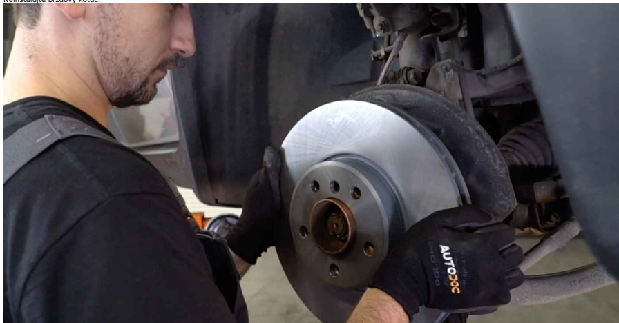
24 Upevnite upevnenie brzdového kotúča. Použite hviezdicový Torx T30. Použite momentový kľúč. Utiahnite ju krútiacim momentom 16 Nm.
