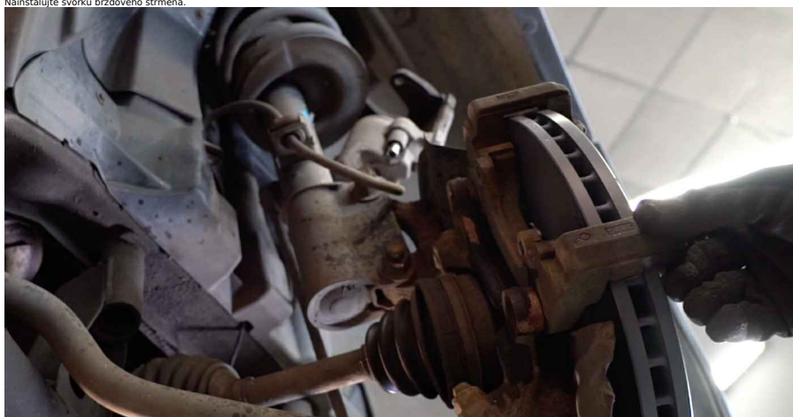
26 Upevnite svorku brzdového strmeňa. Použite nástavec č.16. Použite momentový kľúč. Utiahnite ju krútiacim momentom 110 Nm.
