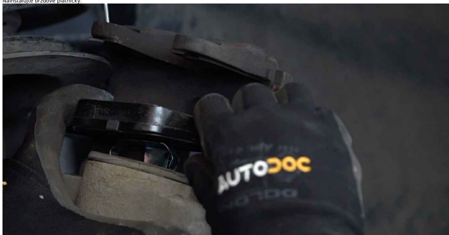
30 Nainštalujte brzdový strmeň a upevnite ho. Použite imbusový kľúč č. H7. Použite momentový kľúč. Uťahnite ju krútiacim momentom 30 Nm.
