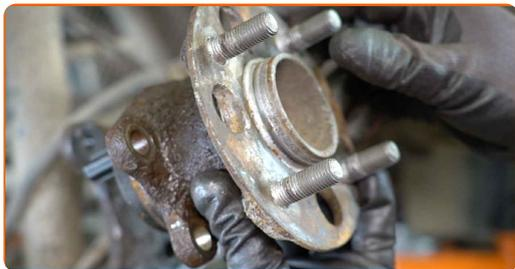
**24** Vyčistite montážny otvor ložiska náboja. Použite drôtenú kefu. Použite viacúčelový čistiaci sprej.
