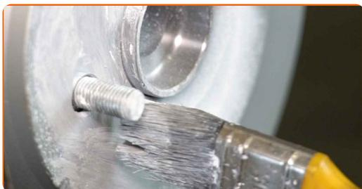
**47** Vyčistite povrch brzdového kotúča. Použite čistič brzd.
