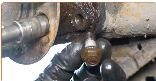
**23** Spolu odstráňte náboj a ložisko, pretože sú v jednej zostave. Použite páčidlo. Použite kladivo.
